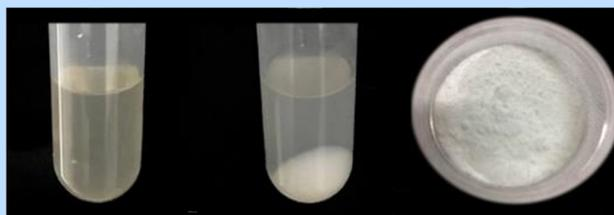
Tras la precipitación de la solución de queratina extraída (izda.), la queratina se hunde hasta el fondo del tubo (centro), pudiendo ser entonces recogida y secada para obtener queratina en polvo (dcha.).
