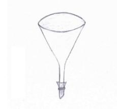
4. Usar o suporte de fixação e uma braçadeira para baixar o funil na tija de vidro. Mergulhar uma parte da extremidade inferior do funil na solução e prender firmemente com o grampo.
