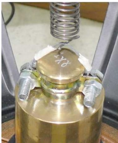
*Nous avons utilisé une boucle en fil de fer accrochée à un serre-joint pour attacher le poids au ressort*
